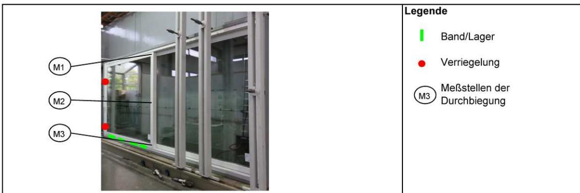
Maximaler Prüfdruck:  $\pm$  800 Pa 3 Druckstöße mit 880 Pa
